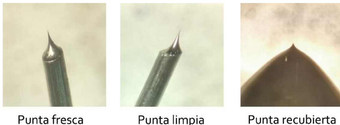
Figura 2.26: Imágenes de microscopio óptico del proceso de limpieza y recubrimiento de una punta de STM para barrer en líquido.
