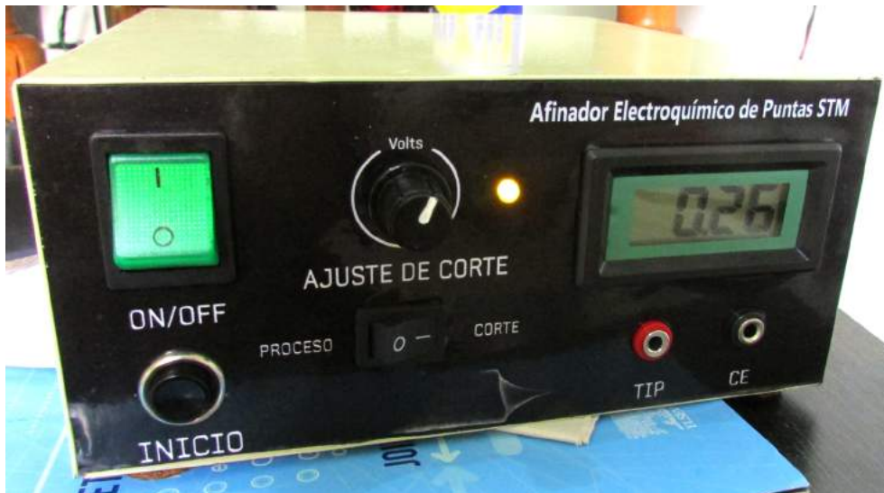
Figura 2.25: Afinador electroquímico de puntas para STM.
