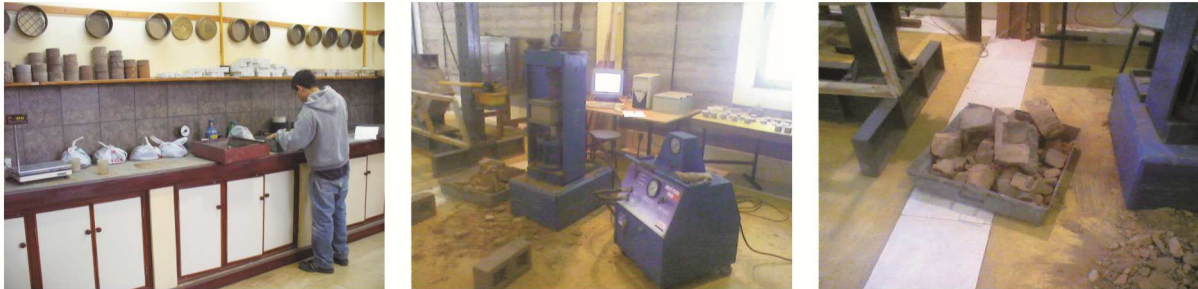
Figura 7. Ensayos de resistencia a la compresión de bloques de suelo-cemento.
