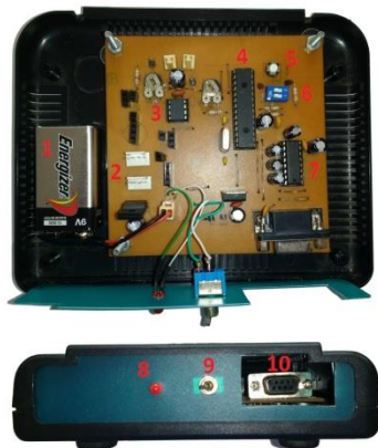
Fig. 1. Vistas superior y lateral del sistema desarrollado: 1) Batería de 9V; 2) Conectores para dos entradas de micrófonos; 3) Amplificador operacional; 4) Microcontrolador PIC; 5) Botón de reset ; 6) Selector de modo de trabajo (uno o dos canales); 7) MAX232; 8) Led indicador de encendido; 9) Interruptor ON-OFF ; 10) Puerto serie.
