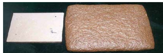
Figura Nº 28: Expansión del cuerpo cerámico.
