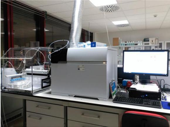
**Figura 12.-** ICP-MS Agilent 7900 en los laboratorios de CIQSO.
