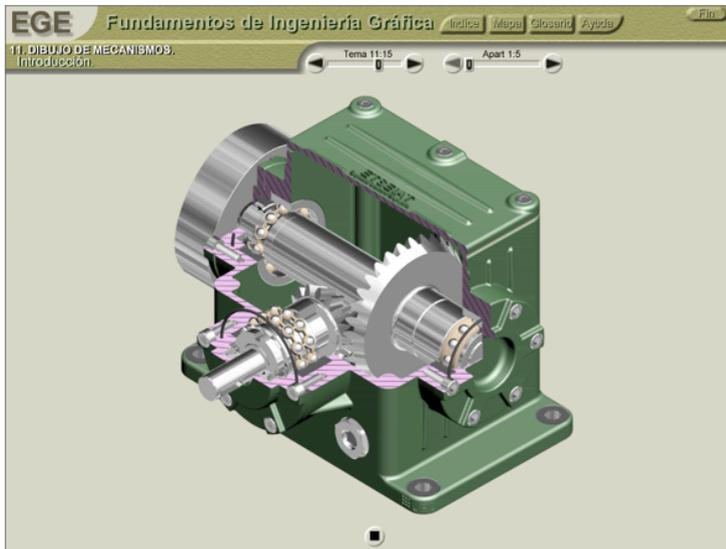
Figura 7. Mecanismos (Reductor de velocidad en movimiento)
