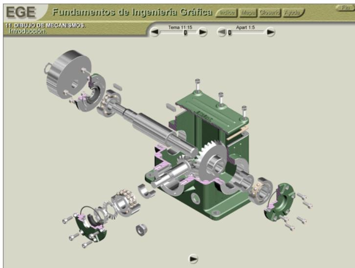
Figura 8. Mecanismos (Reductor de velocidad- Explosión)
