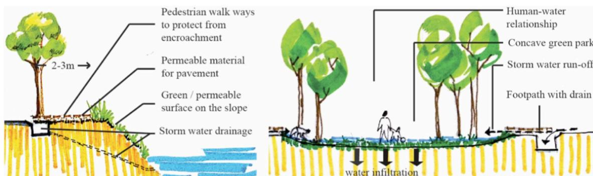
Figura 4. Esquemas de solución de terrenos expuestos a inundaciones en Dhaka.
