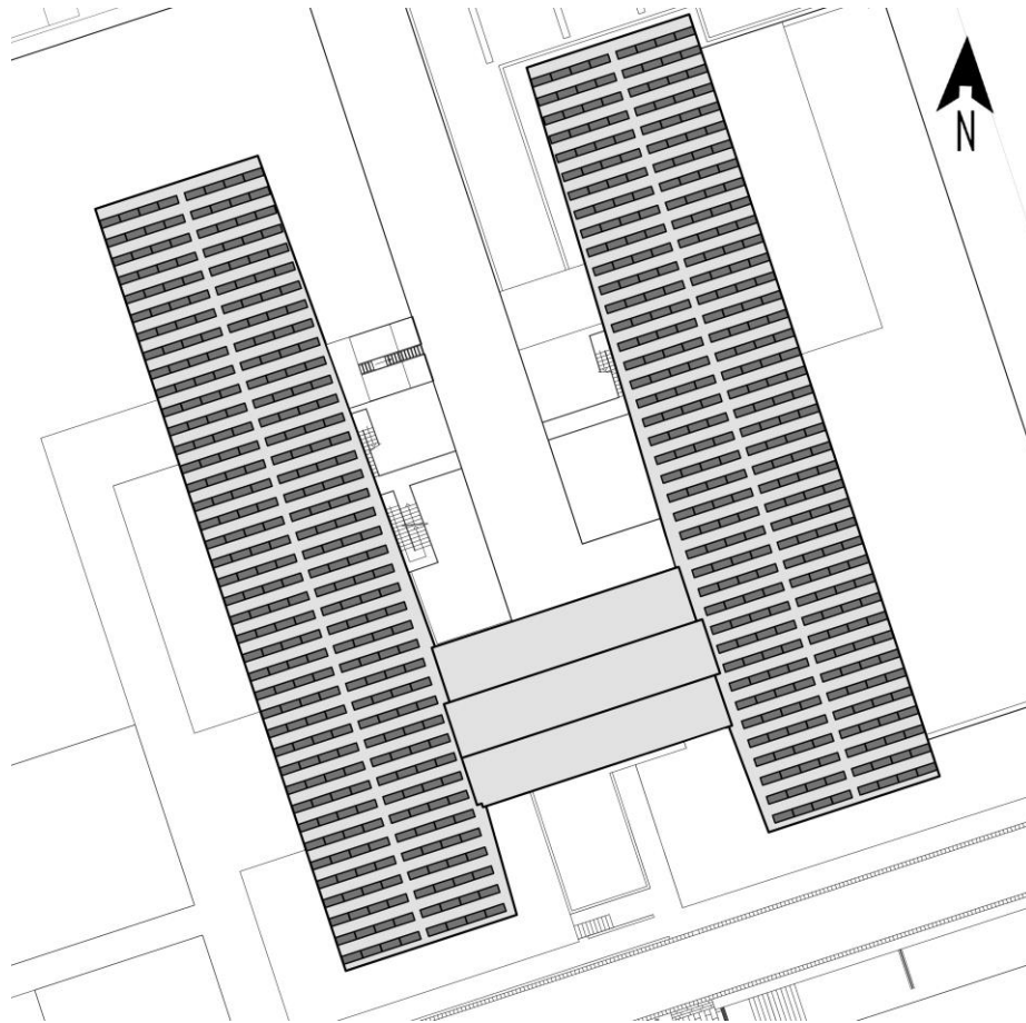
Figura 68. Localización de paneles fotovoltaicos en cubierta
