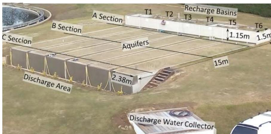
Figura 5. Vista general de los sistemas de recarga artificial, con sus zonas de recarga y descarga y puntos de observación y muestreo (Valhondo et al., 2019).
