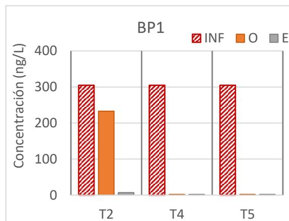
**Figura 22. Concentraciones promedio de BP1 (ng/L) medida en el agua de infiltración (rallas rojas), en las muestras del piezómetro O (barras naranjas) y en el efluente (Barras grises) de los sistemas T2, T4 y T5 en la etapa 2.**
