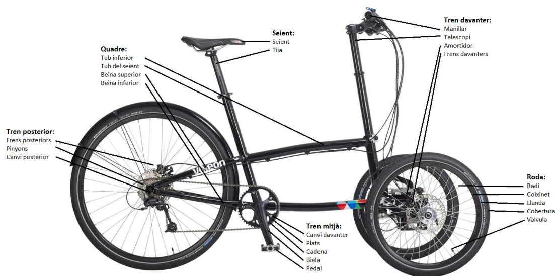
Il·lustració 2. Distribució dels components d'un tricicle tipus tadpole
