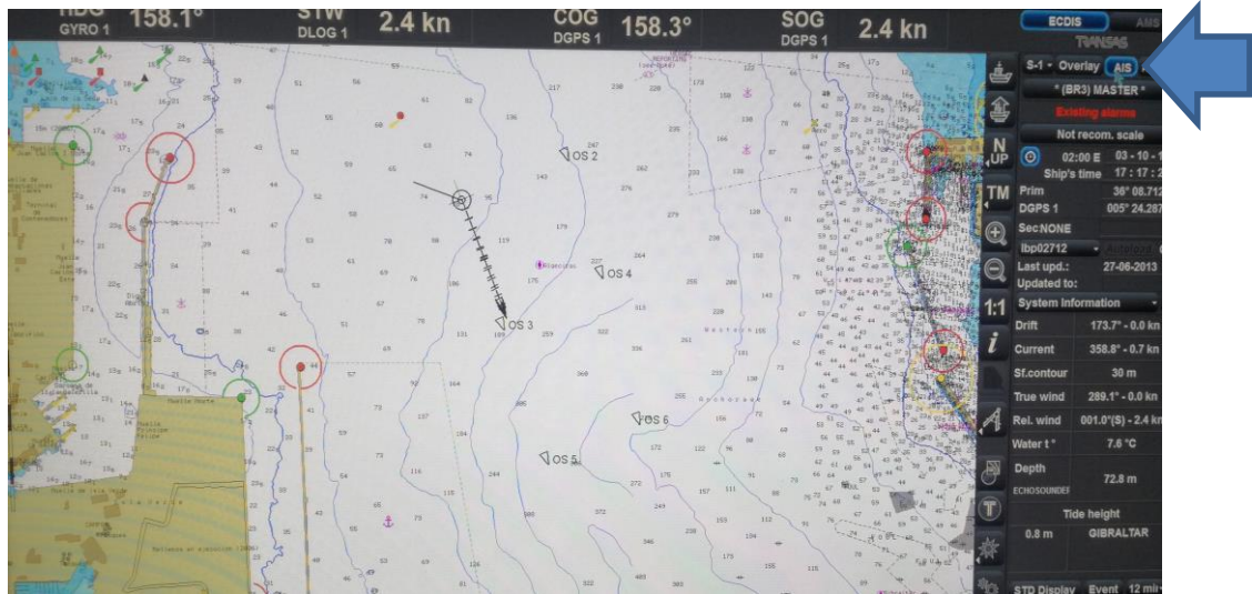
Figura 39. Integración del AIS en el ECDIS. Fuente: propia, del simulador de la FNB.
