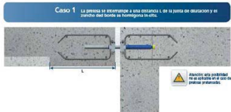
Figura 9. El subministrador posa alerta sobre l'ús dels "goujons" en combinació amb plaques prefabricades pretesades, i també del risc de situar l'eix del passador fora de la línia neutra
