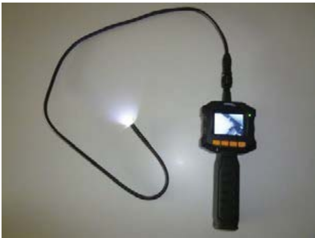
Figura 12. Endoscopi utilitzat per a la realització de la inspecció de l'interior de l'esquerda
