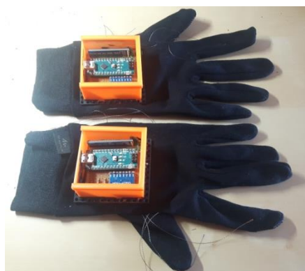
Figura 4.14. Foto del resultado final de la impresión y cosido a los guantes.
