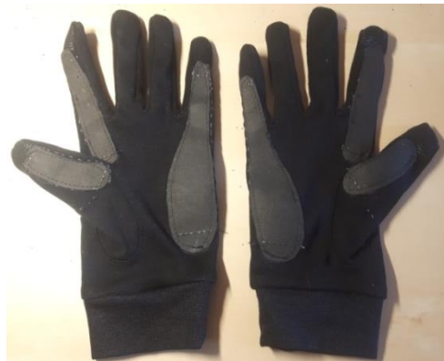
Figura 4.1. Guantes con los fragmentos de tela con reactancia cosida.
