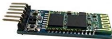
Figura 3.12. Módulo DSD Tech HC-05 para Arduino [20].
