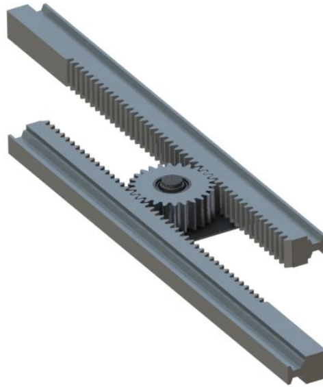
Figura 37. Sistema piñón-cremallera utilizado en el diseño. (Fuente: Propia)
