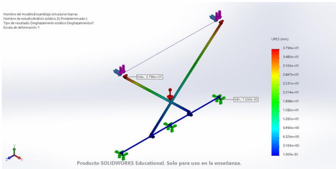
Figura 56. Desplazamientos estáticos del mecanismo de elevación. (Fuente: SolidWorks)
