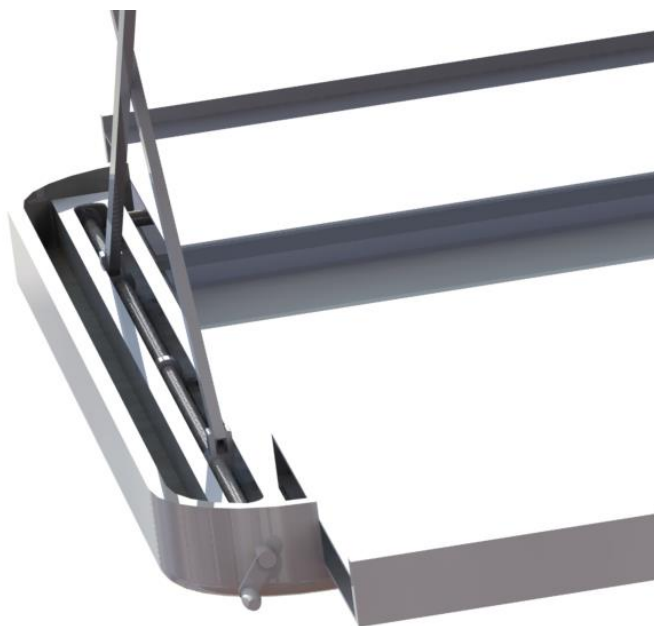
Figura 15. Sistema de elevación y apertura mediante manivela. (Fuente: Propia)
