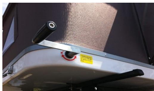
Figura 10. Sistema de apertura mediante manivela. (Fuente: BigFoot Tents)
