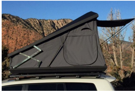
Figura 11. Sistema de apertura similar al de un canapé. (Fuente: Eezi Awn)
