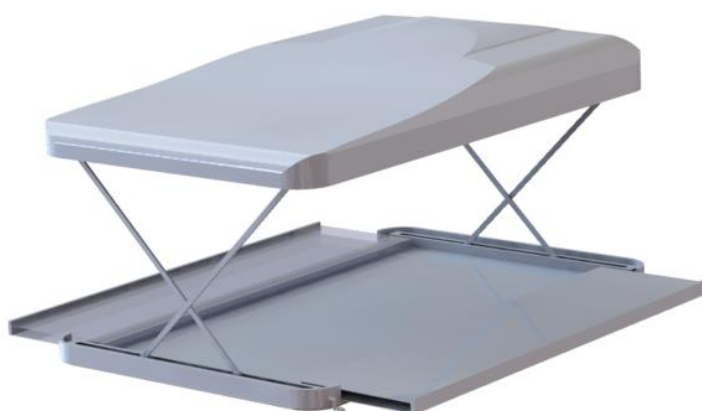
Figura 17. Diseño preliminar de la tienda sobre techo con manivela. (Fuente: Propia)
