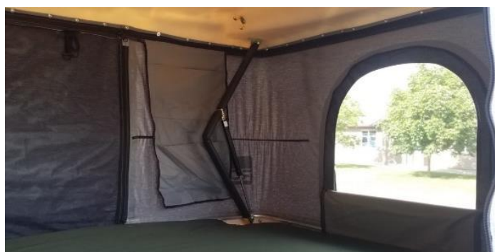
Figura 9. Sistema de apertura mediante pistón de gas y unión articulada. (Fuente: Autohome)
