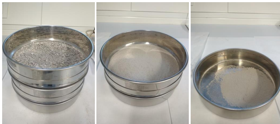
Imagen 4: A) Tamaño de partícula mayor que 0,355 mm B) Tamaño de partícula entre 0,355 mm y 0,1 mm C) Tamaño de partícula más pequeño que 0,1 mm
