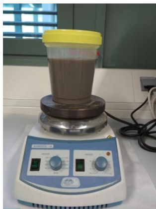
Imagen 5: Proceso de formación de los lixiviados con agitación magnética
