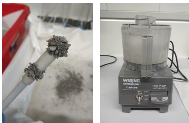
Imagen 2: A) Eliminación de partículas ferrosas B) Molino utilizado para disminuir el tamaño de partícula
