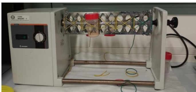
Imagen 9: Proceso de intercambio iónico en el agitador rotatorio
