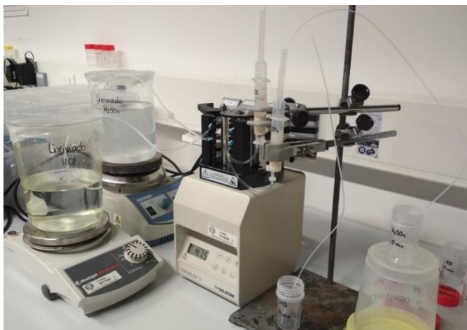
Imagen 11: Puesta en marcha del proceso de intercambio iónico
