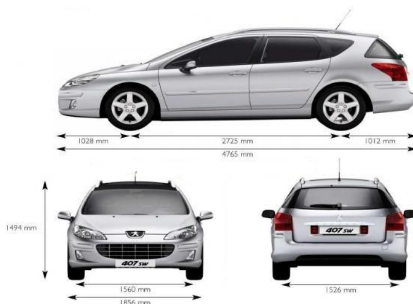
Figura 11: Dimensiones del vehículo Peugeot 407 Sw (Fuente: web de Peugeot)
