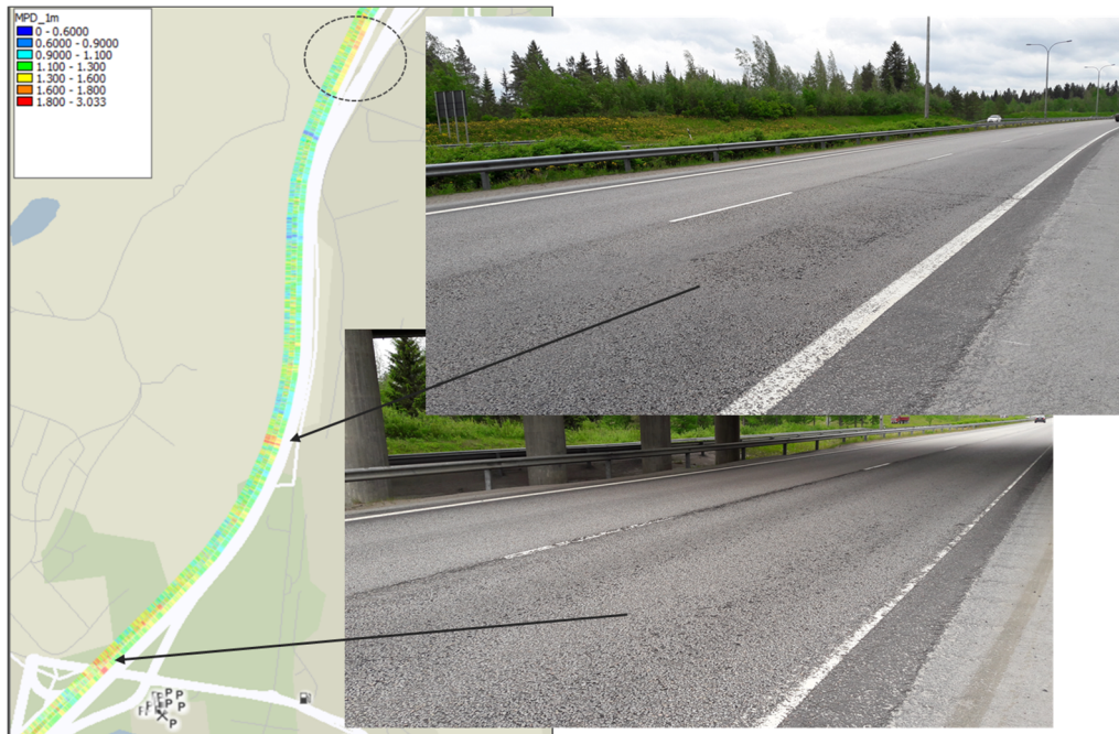
Kuva 24. Kohteen G karkeudeltaan poikkeavia jaksoja, jotka näkyvät kartalla punaisina ja karttaan ympyröity keltaoranssina näkyvä jakso, joka silmämääräisesti ei vielä ollut karkeuden perusteella korjattava.
