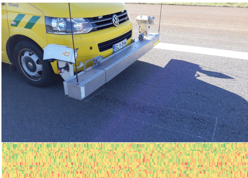
Kuva 1. Kuvassa PTM-mittauslaitteisto ja alla koko poikkiprofiilista lasketut karkeustulokset noin 25 metrin matkalta. Punaiset alueet kuvaavat karkeampaa ja vihreät sileämpää päällystettä.
