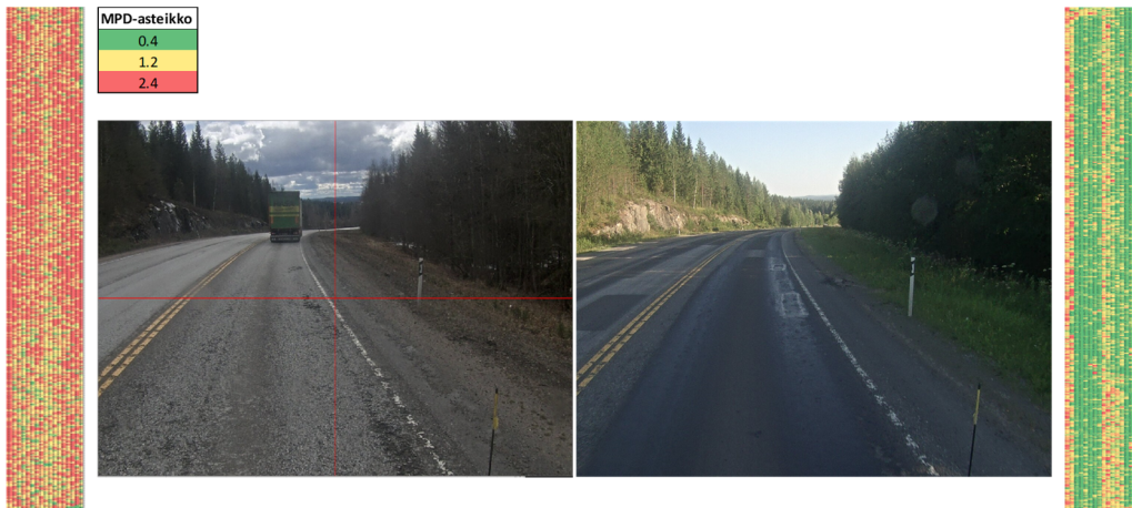
Kuva 6. Esimerkki SIP-toimenpiteen vaikutuksesta pinnan karkeuteen (oikean kuvan oikeassa reunassa näkyy sirotepintauksen alla kuumapaikka).
