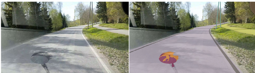
Kuva 6. Esimerkki kuinka kojelaudalla olevat esineet voivat häiritä konenäköä, kun kameran linssin edessä ei käytetä polarisaatio-suodatinta.
