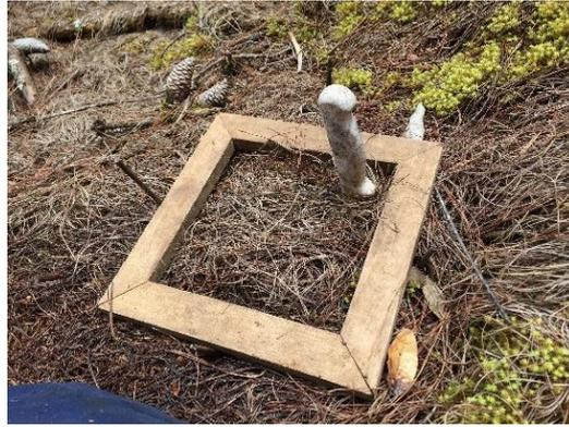
Fig 4. Corte del contorno del marco de madera para recolección de muestra.
