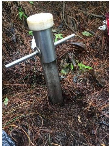
*Figura 7. Toma de muestra de la capa mineral con el barrenó.*
