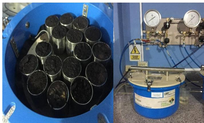
Figura 15. Anillos colocados en los extractores de presión
