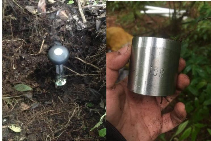
*Figura 8. Toma de muestra inalterada (anillo de Kopecky).*
