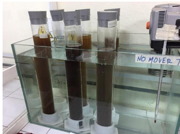
*Figura 13. Método del hidrómetro*
