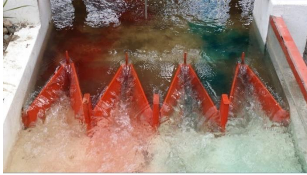
Figura 4.18 Distribución del flujo de aproximación hacia el vertedero de excesos.
