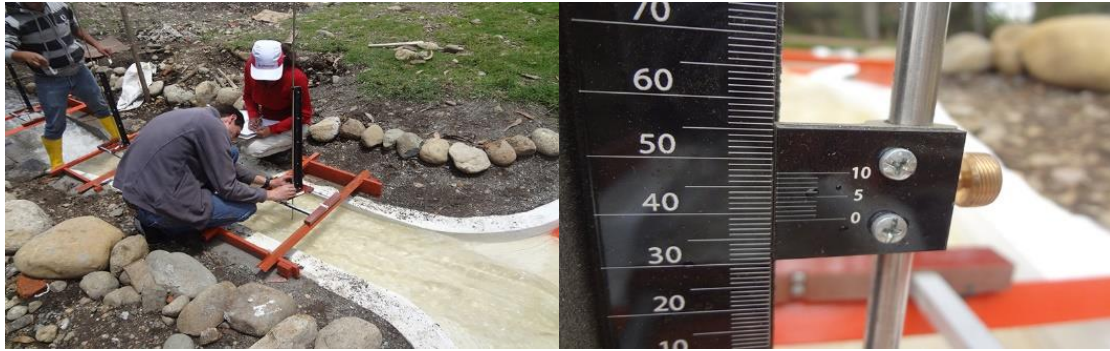
Figura 3.21 Limnímetros de precisión
