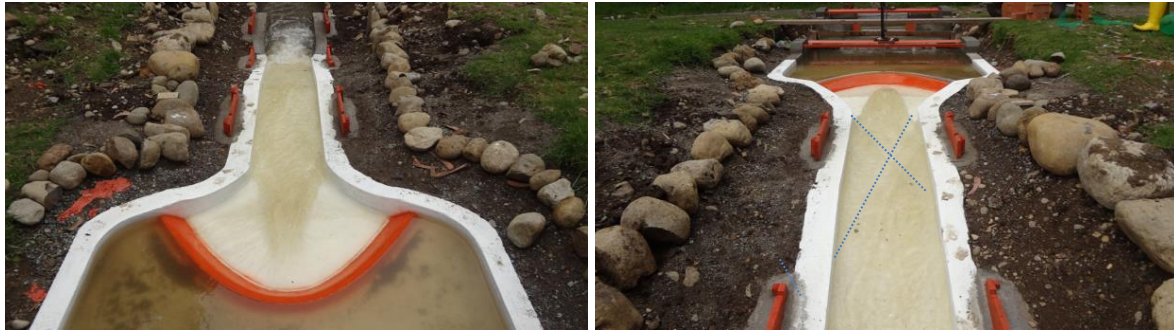
Figura 4.5 Distribución del flujo aguas abajo del vertedero de excesos para un caudal de 240.41 m 3 /s
