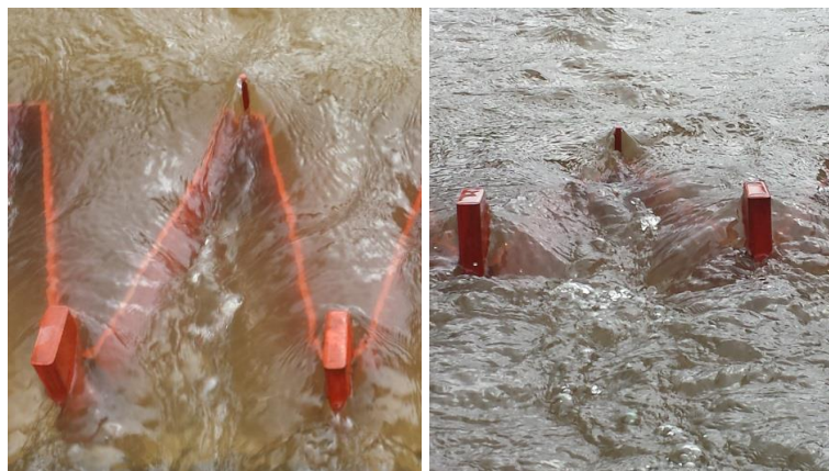
Figura 4.21 Efectos de sumergencia en el módulo del vertedero en laberinto. Izquierda: Sumergencia local Q= 1020.50 \text{ m}^3/\text{s} ; Derecha: Sumergencia aguas abajo Q= 1090.40 \text{ m}^3/\text{s} .
