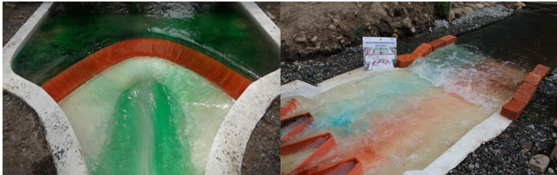
Figura 3.22 Observación del patrón y dirección del flujo con trazadores
