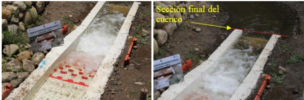
Figura 4.15 Alternativa 2: Distribución de datos de impacto en la sección inicial de la rápida 4 (la línea roja representa el final del cuenco amortiguador)
