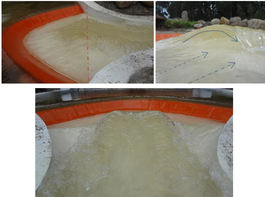
Figura 4.7 Características del flujo aguas abajo del aliviadero para el caudal de diseño (AMP) 326.44 m 3 /s
