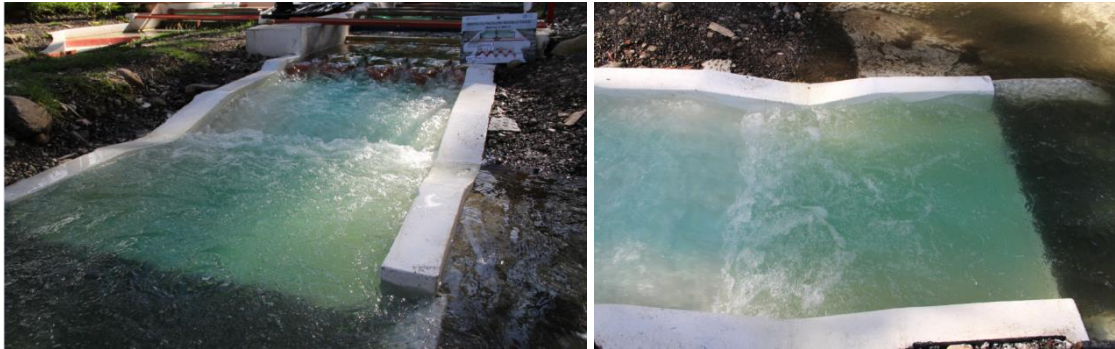
Figura 4.35 Alternativa 2: Distribución del flujo dentro del cuenco amortiguador, Q= 1017.50 \text{ m}^3/\text{s} .
