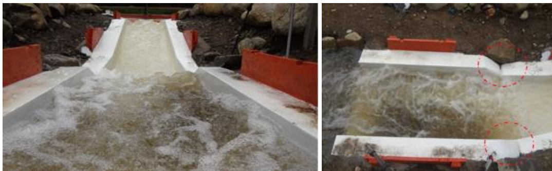
Figura 4.11 Visualización del comportamiento del flujo dentro del cuenco amortiguador.
