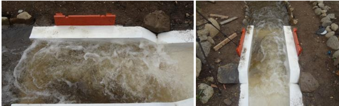
Figura 4.10 Evaluación de la eficiencia del cuenco amortiguador.
