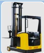
Equipos de carga lateral: estos equipos posee la facultad de descargar por los lados, lo cual resulta conveniente porque permite ahorrar espacio en los pasillos. El ancho de pasillo requerido para su desplazamiento es de 2.20 metros.
