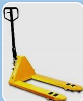
Carretilla tipo walkie: permite levantar y estibar un pallet por una distancia corta. El manipulador maneja a pie, a un costado del equipo, y camina con la carretilla durante el recorrido.
