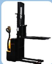
Equipos pórticos extensibles: básicamente, son los equipos pórticos con un mecanismo adicional, lo que les dota de un alcance mayor. El ancho de pasillo requerido para su desplazamiento es de 2.50 a 3.20 metros.
