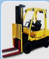
Montacargas de contrapeso: posee un contrapeso en la parte superior y levanta la carga sobre un mástil delantero. Habitualmente utiliza dos horquillas, pero esto puede variar según la carga. Su manipulador va sentado.
