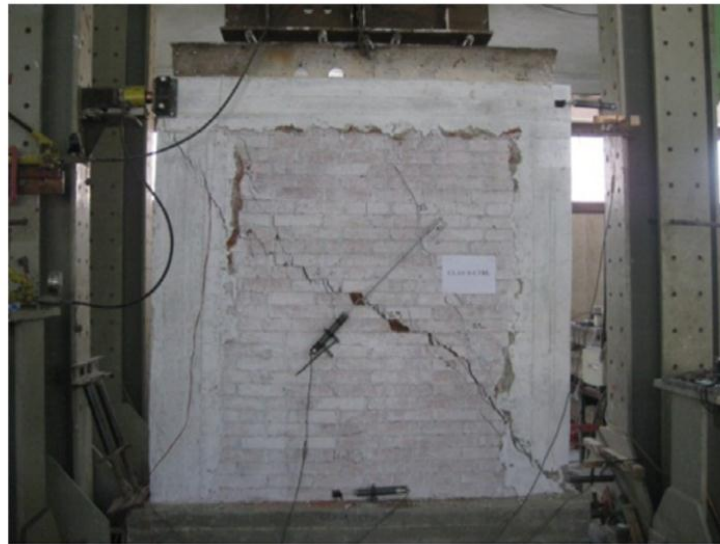
Figura 54. Patrón de fallas para pared llena obtenido del ensayo experimental (tomado de Okail, et al. ,2012)
