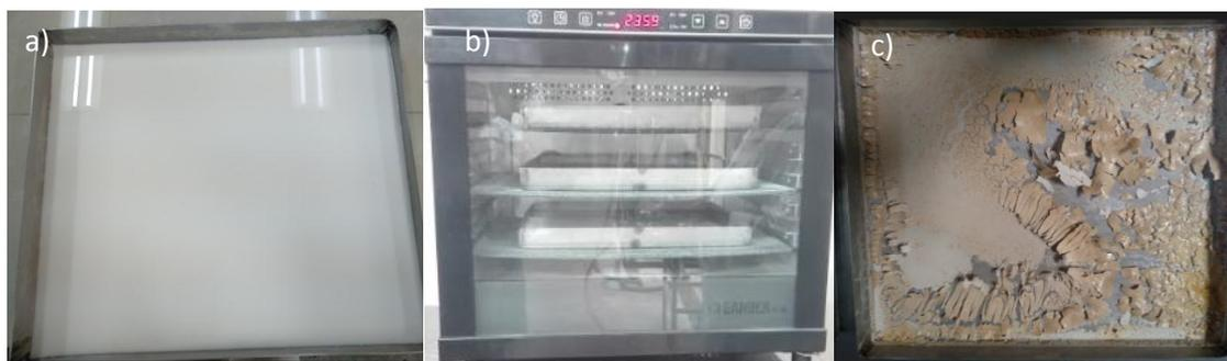
Ilustración 10 a) Bandeja de filtrado de almidón. b) Secador c) Almidón obtenido después del proceso de secado.
