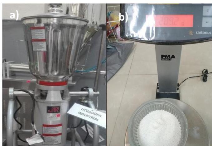
Ilustración 11 a) Trituración del almidón en la licuadora industrial. b) Pesado del almidón obtenido.
