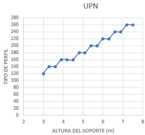
Gráfica 5.2: Resultado del número de perfil UPN en función de la altura. Elaboración propia.
