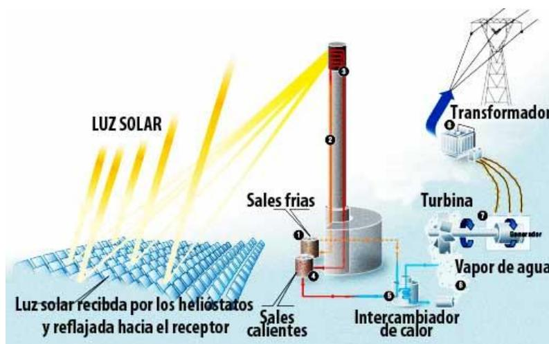
Figura 8. Esquema de una central solar térmica de torre [8]
