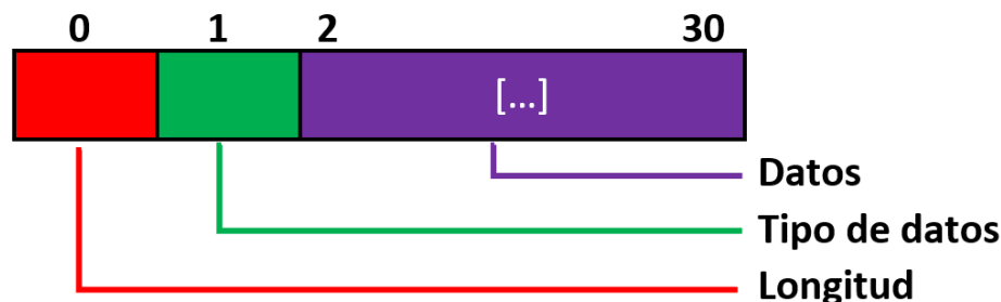
Figura 22: Formato de la carga útil del Advertising data
