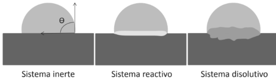
Figura 6. Tipos de sistemas en función de la solubilidad y reactividad entre fase líquida y sólida [12].
