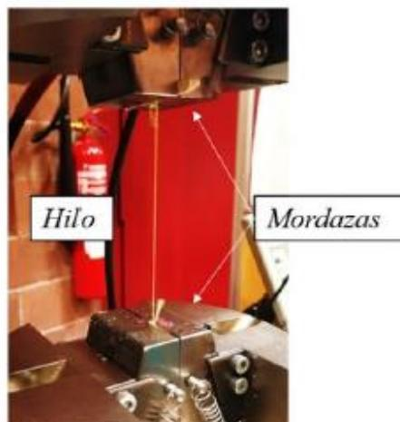
Fig. 3.2. Máquina universal de ensayos INSTRON 8516 realizando ensayo de tracción uniaxial.
