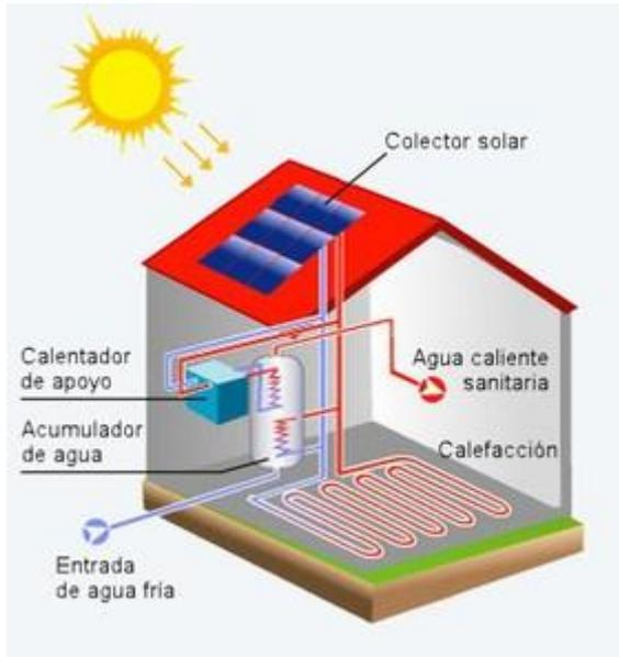
Fig. 12. Sistema solar para ACS y calefacción. Obtenido de [13]
