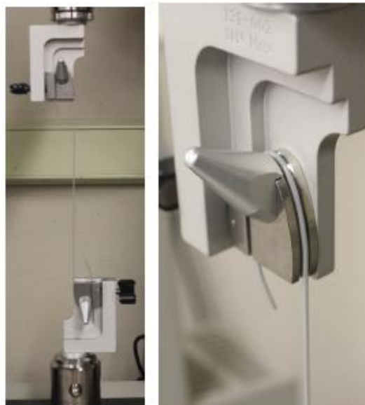
Figura 21. Ensayo de tracción de filamento de PLA [11].
