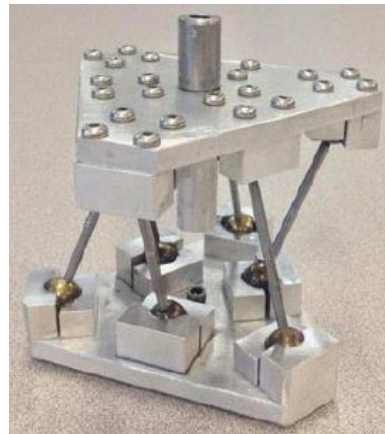
Imagen 25: Mecanismo convertidor de traslación-rotación alternativo para suspensión regenerativa por generador rotativo. Fuente: [42]
