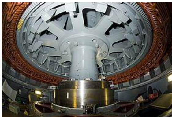
Imagen 8: Vista inferior de uno de los volantes de inercia del JET. Fuente: www.euro-fusion.org
