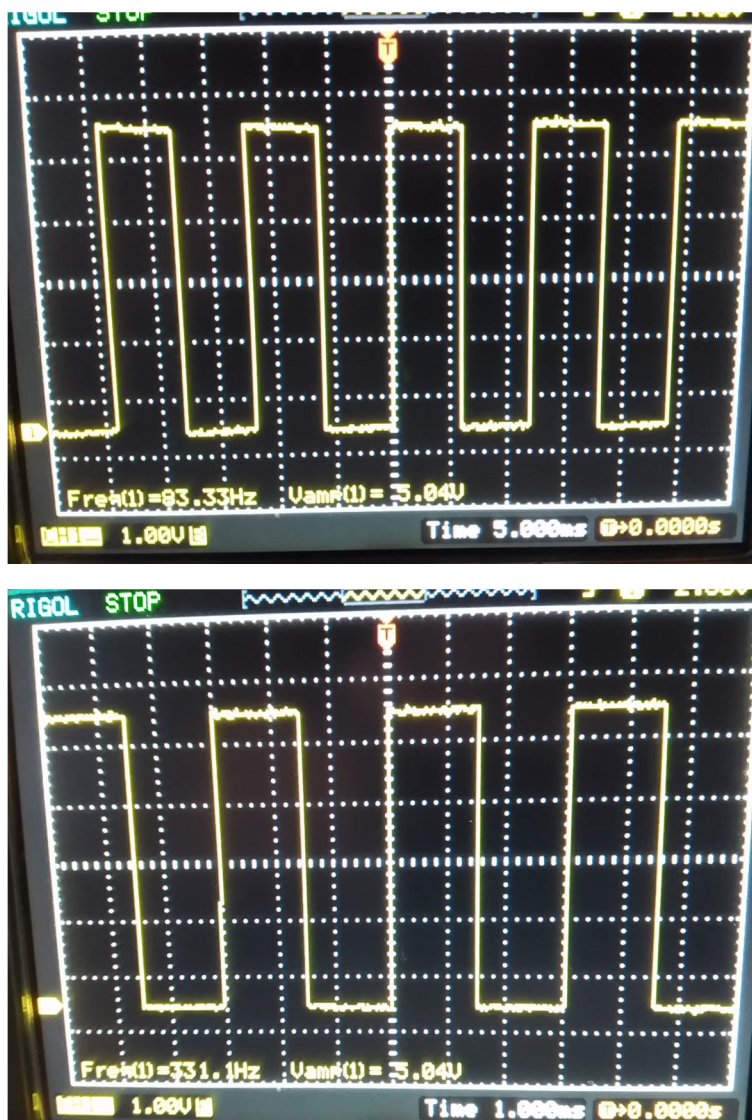
Figura 3.34. Respuesta real del oscilador CD4046.
