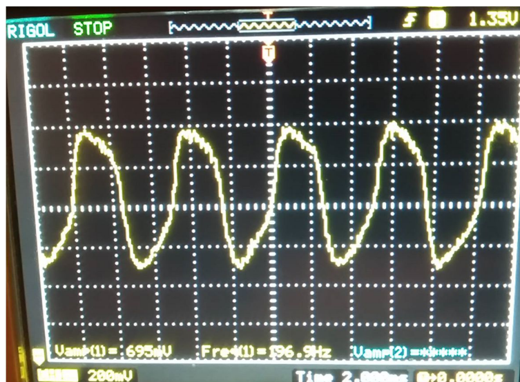
Figura 3.26. Respuesta real del oscilador en puente Wien con fuente única.
