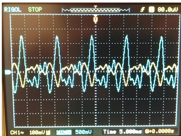
Figura 3.6. Respuesta real del filtro de 1 er orden con BJT ante nota E.
