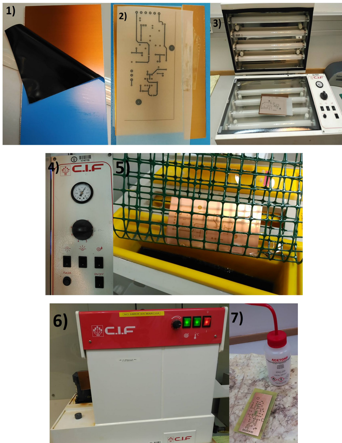
Figura 3.49. Proceso de fabricación de la PCB.
