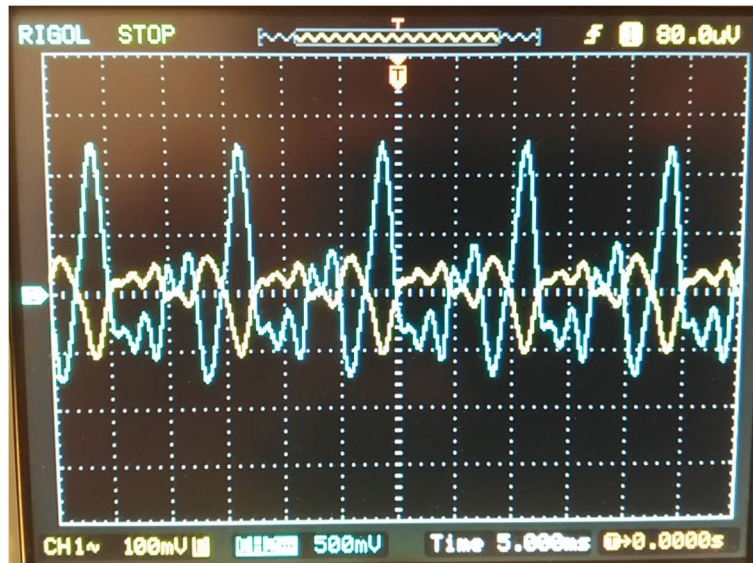
Figura 3.17. Respuesta real del circuito S-K y alimentación simétrica ante nota E.
