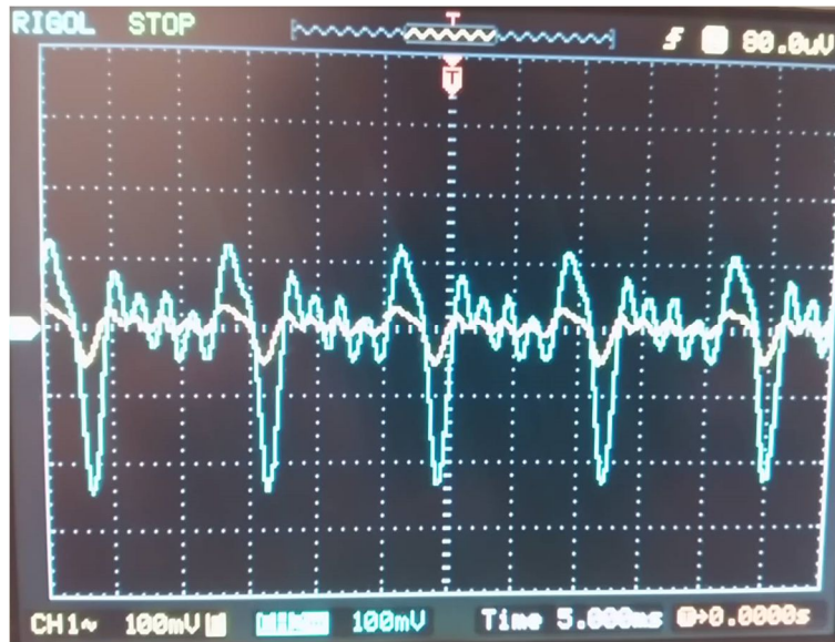
Figura 3.10. Respuesta real del filtro de 8° orden activo ante nota E.
