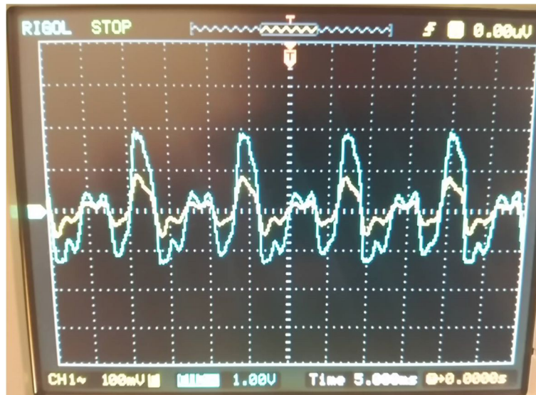
Figura 3.3. Respuesta real del filtro de 2º orden activo ante nota E.
