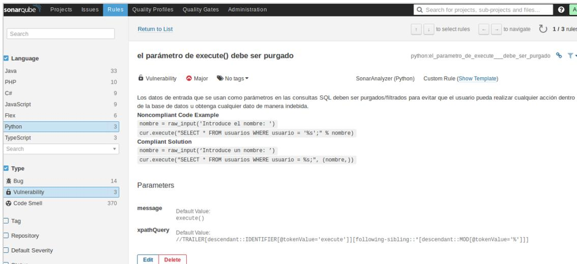
Fig. 34. Regla SQL Injection en SonarQube
