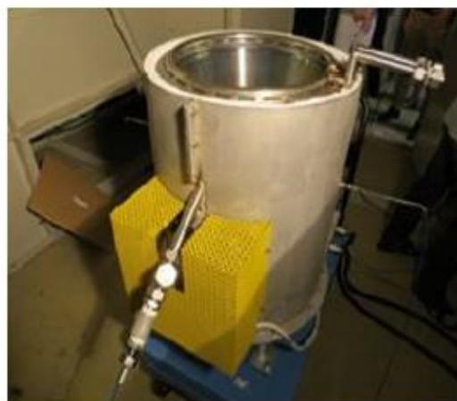
Ilustración 19: Receptor de lecho fluidizado de 30 KWth con ventana [14, p.3]
