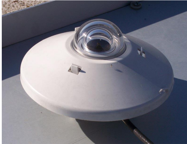
Ilustración 53: Piranómetro o pirheliómetro [27, p.15]
