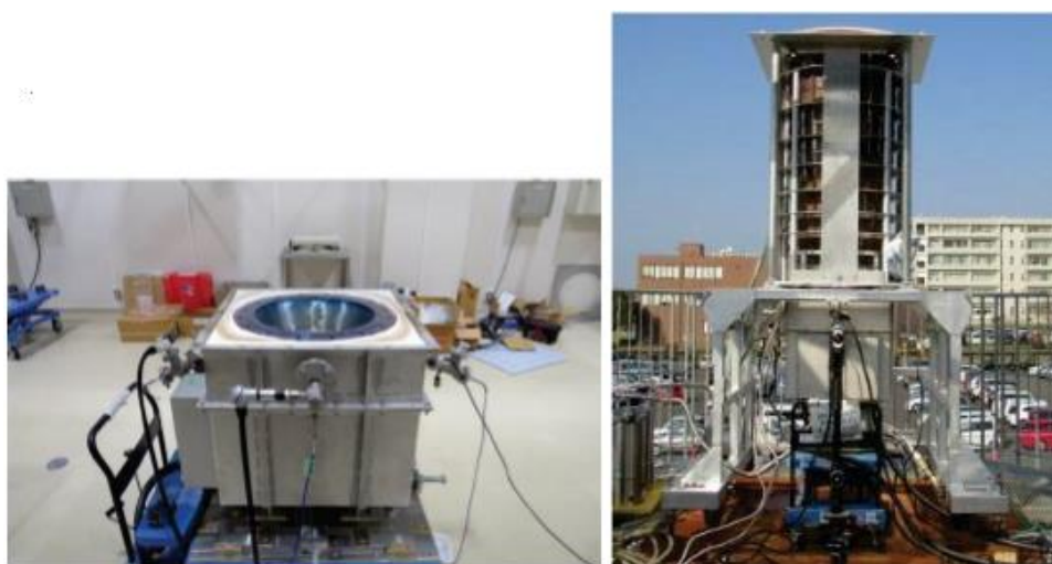
Ilustración 20: Receptor instalado en Miyazaki y su colocación
