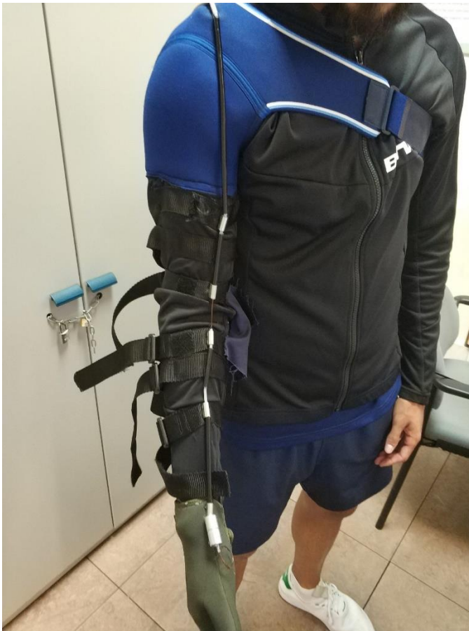
Fig. 3.17: Visualización del cable SMA en la zona del codo
