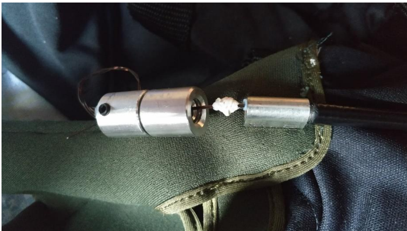
Fig. 3.20: Recubrimiento de teflón entre piezas metálicas
