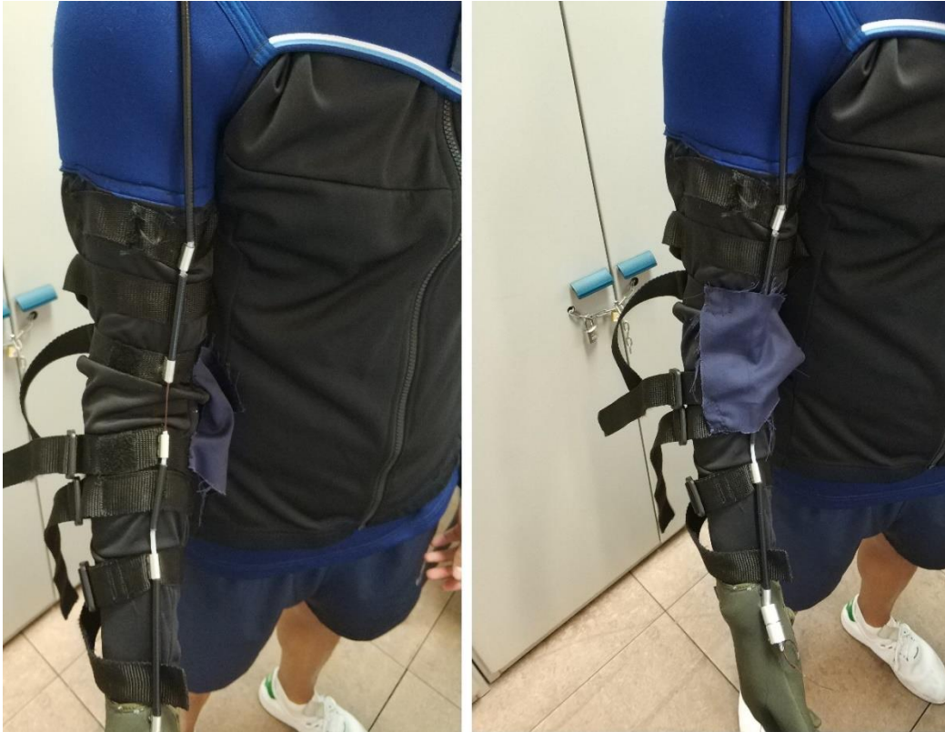
Fig. 3.19: Aislamiento del hilo SMA en la fosa del codo
