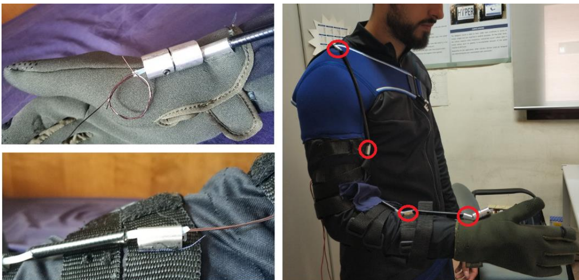
Fig. 3.14: Instalación del elemento de fijación sobre el guante, las cintas de polipropileno y la hombrera
