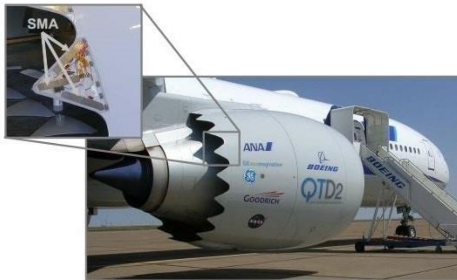
Fig. 2.6: Turbina con geometría variable de Boeing [4].
