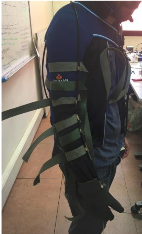
Fig. 1.4: Malla actuada mediante fibras de SMA
