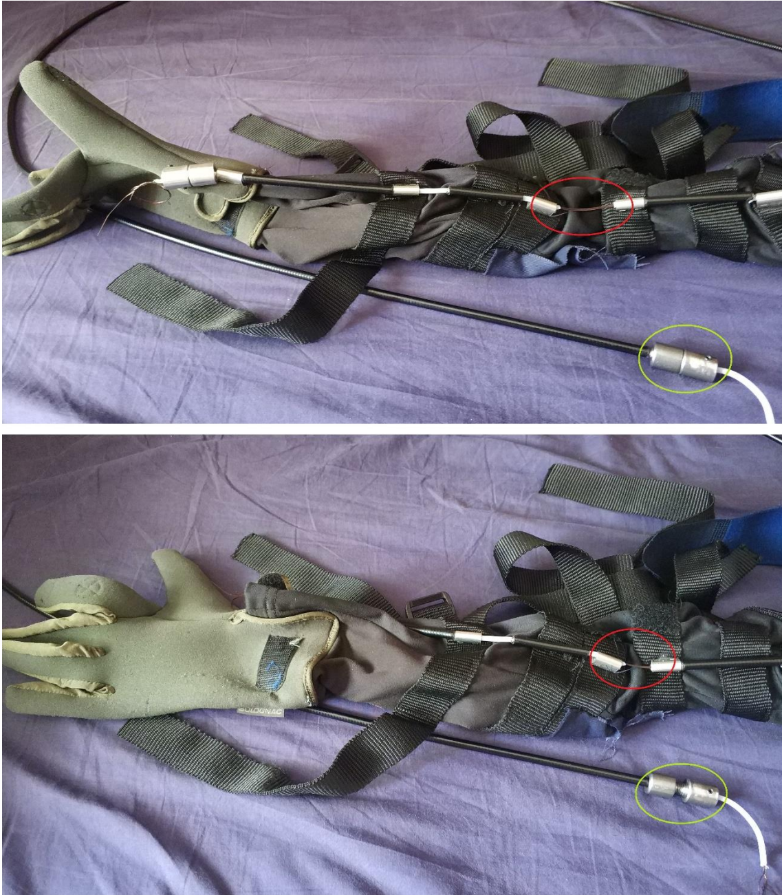
Fig. 3.11: Tensado de los hilos mediante la pieza de crimpado
