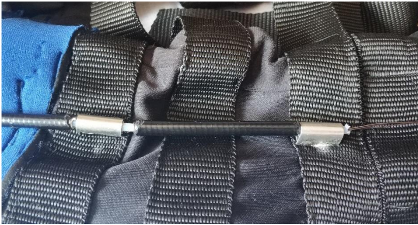
Fig. 3.22: Vista en detalle del cable Bowden instalado en la malla.
