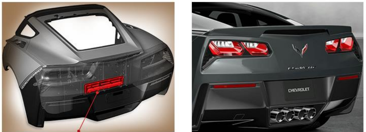
Fig. 2.2: SMA que permite abrir una rendija del maletero para eliminar el aire interior [4].
