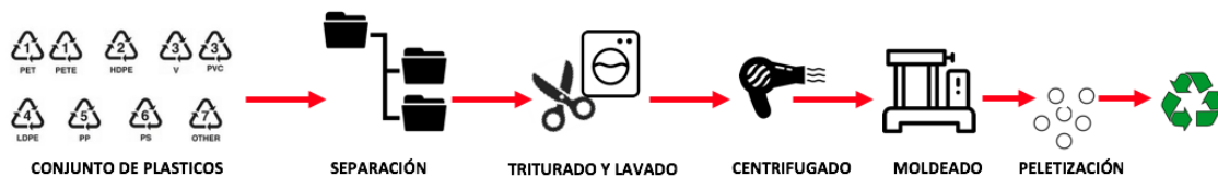
Figura 4 Proceso de tratamiento de termoplásticos.
