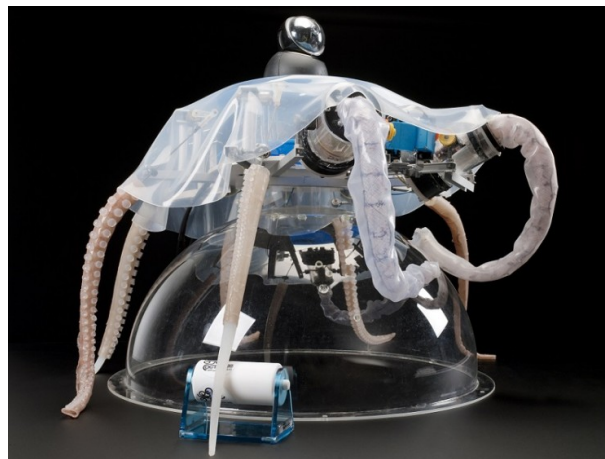
Figura 1: Robot blando OCTOPUS de la Scuola Superiore Sant' Anna (SSSA).
