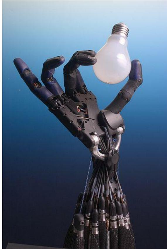
**Figura 4: Shadow Hand sujetando una bombilla**
