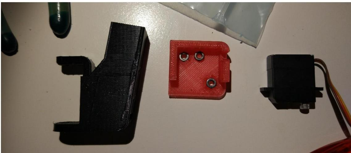
Figura 38: Vista de los elementos que componen el conjunto abductor. De izquierda a derecha: *elementos abductor*, *servo\_housing* y *servomotor*
