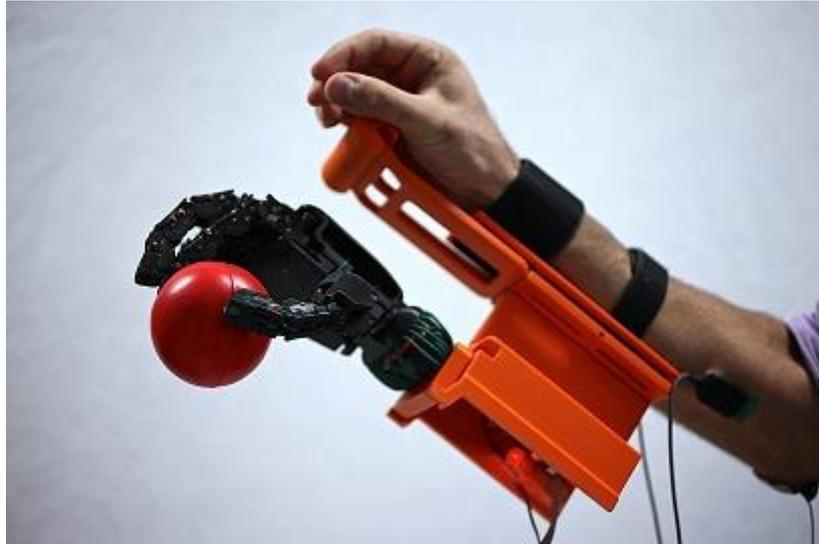
**Figura 7: SoftHand sujetando una pelota**
