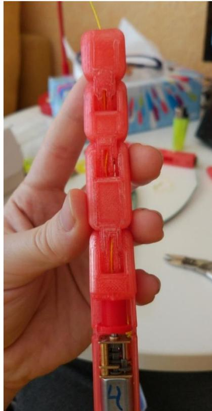
Figura 37: Módulo de dedo completamente montado
