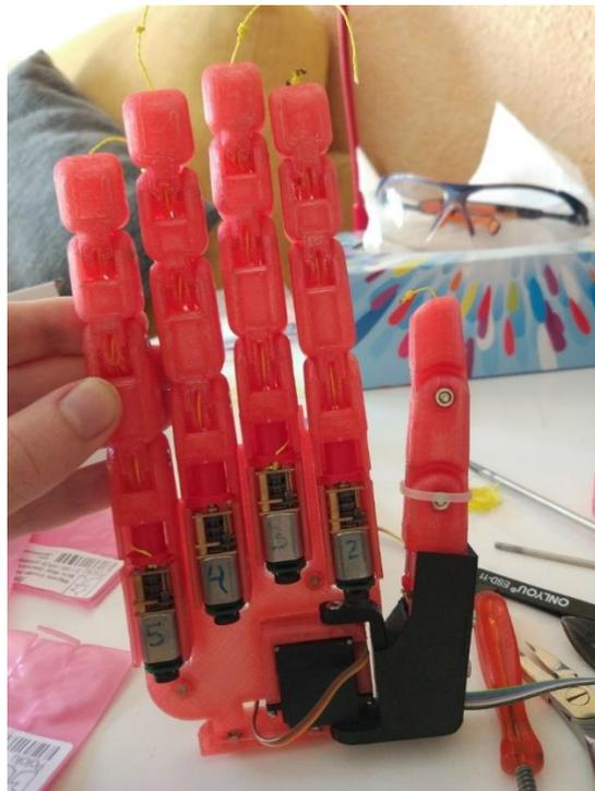
Figura 41: Módulos de dedo y conjunto abductor fijados al elemento dorsal visto de frente
