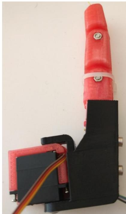
Figura 39: Montaje final del dedo pulgar junto con el abductor
