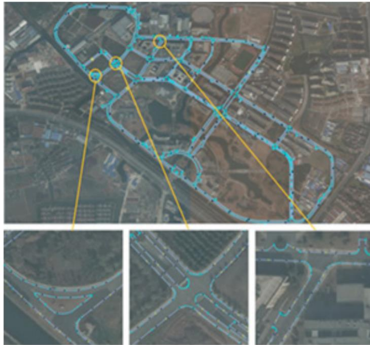
Fig. 9: Mapa digital obtenido mediante detección de bordillos. Fuente: L. Wang et al. [46]
