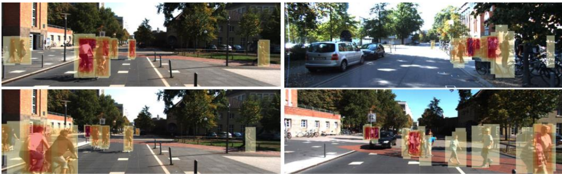
Fig. 21: Ejemplo de detecciones Kitti erróneas de peatones y ciclistas.
