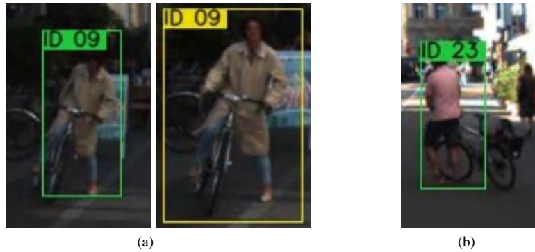
Fig. 69: El agente cambia de verde (peatón) a amarillo (ciclista) cuando la persona se monta en la bici (a). En (b), una persona es correctamente detectada como peatón, pese a caminar con una bici.
