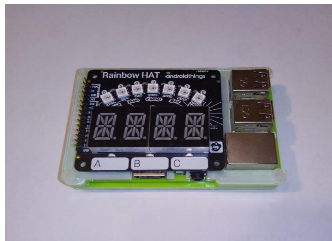
Ilustración 12: Resultado final del montaje de la Raspberry Pi, PiBow Case y el Rainbow Hat
