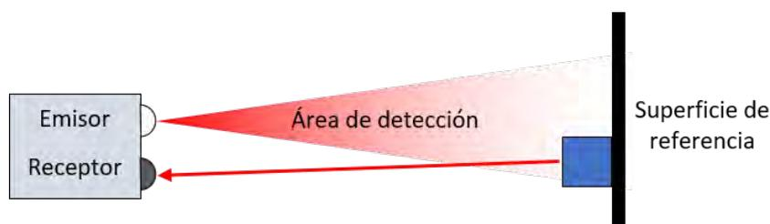
Fig. 3.8. Sensor de detección con supresión de primer plano.
