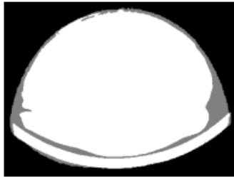
Figura 6. Rodaja central de la máscara obtenida con el escáner de superficie (en gris) superpuesta con la misma rodaja de la máscara ideal (en blanco)
