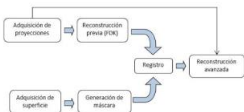
Figura 1. Flujo de trabajo propuesto para tomografía de ángulo limitado
