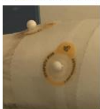
Figura 2. Posición de los marcadores sobre la muestra bajo estudio
