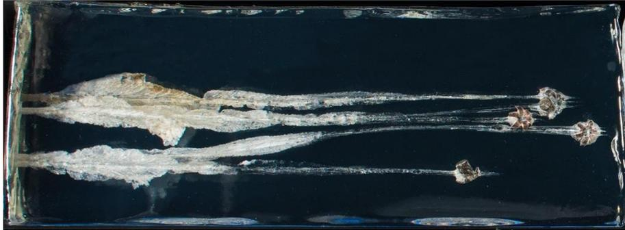
*Figura 35: Detalle de daños producidos por proyectiles Hollow-Point.*
