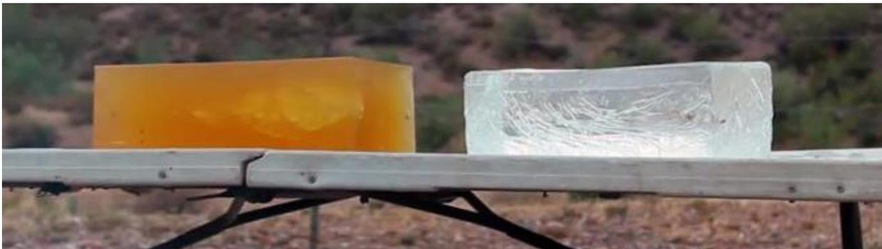
*Figura 34: Detalle de un bloque de gel balístico orgánico y uno sintético transparente*
