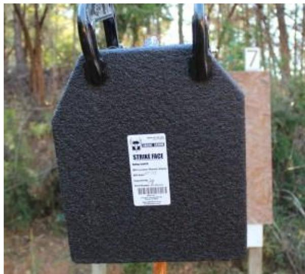
*Figura 21: Detalle de la fijación de placa para test de impacto*
