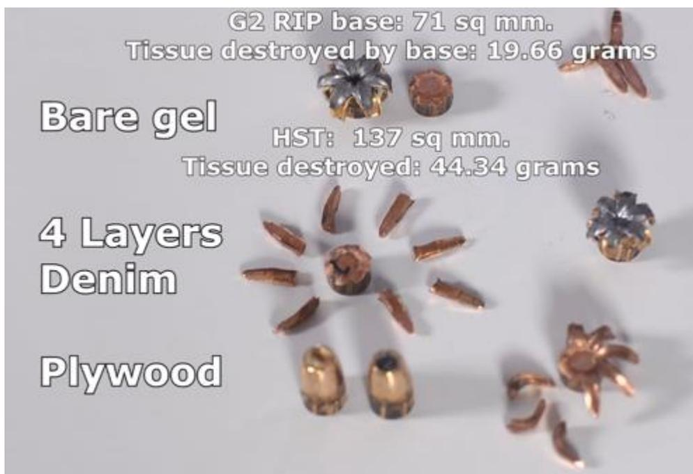
Figura 16: Comparación del estado de cada munición tras el ensayo.
