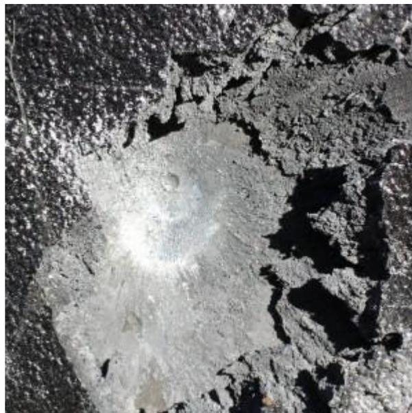
*Figura 24: Detalle de fragmentación del PAXCON*
