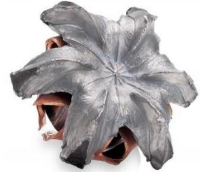
*Figura 3: Detalle de la expansión de una bala Hollow-point.*
