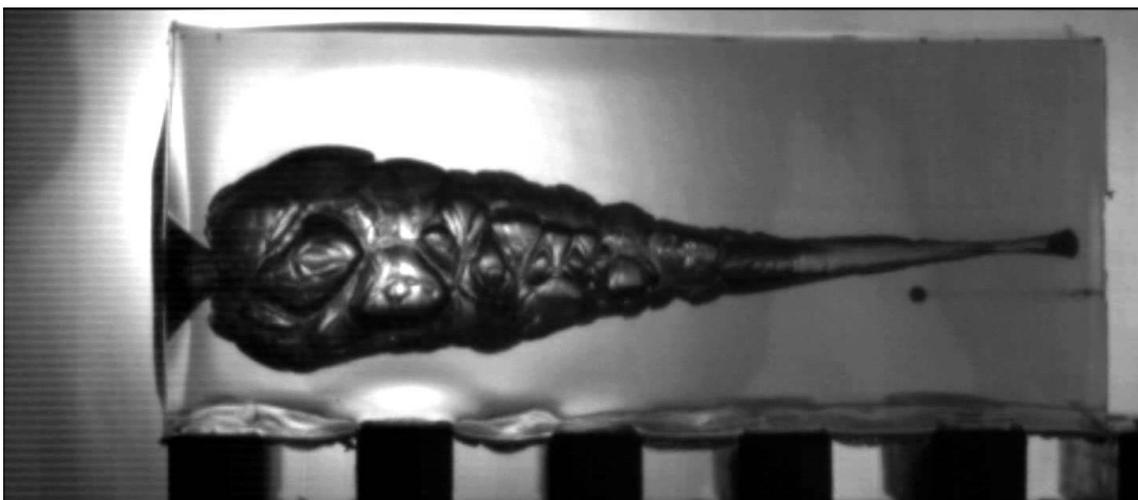
*Figura 33: Detalle de gel balístico en un ensayo de impacto.*
