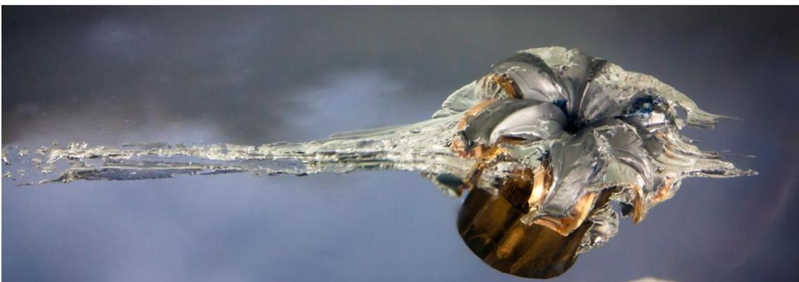
*Figura 19: Detalle de Hollow-Point en el interior de gel balístico*
