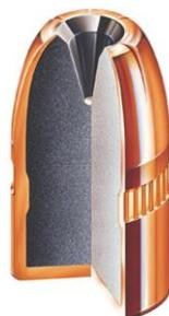
*Figura 2: Dibujo esquema de bala Hollow-point con vista en corte.*
