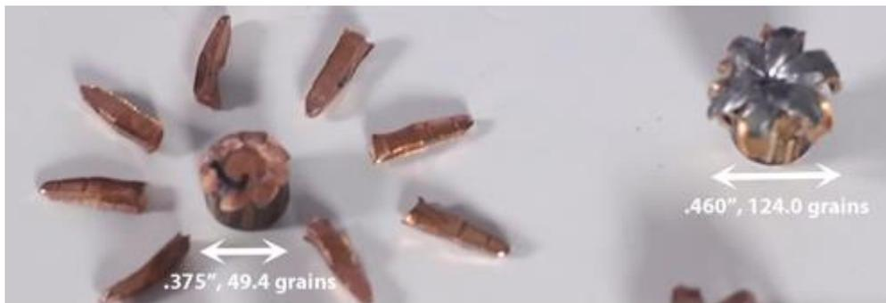
Figura 13: Detalle del proyectil recuperado del gel.
