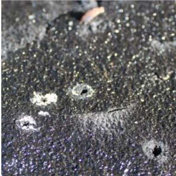
*Figura 23: Detalle de penetración en el PAXCON*
