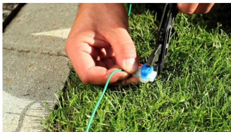
Ilustración 22: Colocación de marcadores para cortacésped.
