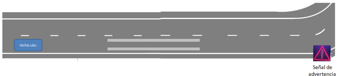
Figura 66: Montaje de módulo de PZTs para iluminar una señal de advertencia
