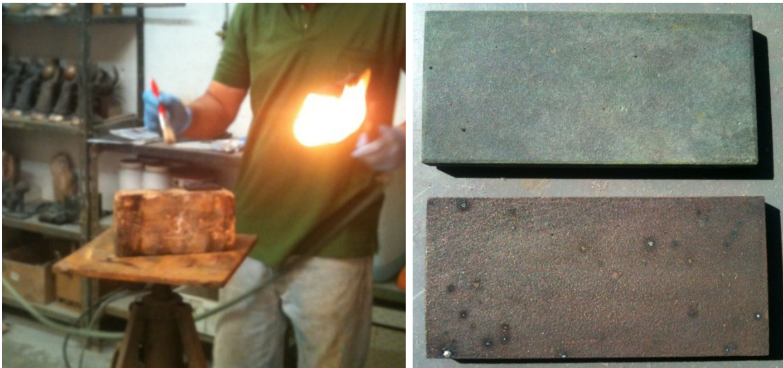
Figura 4. Proceso de patinado de las muestras en la fundición (izda) y pátinas resultantes: pátina tostada a base de sulfuro potásico (inferior) y pátina verde de cloruro amónico sobre base de sulfuro (superior).
