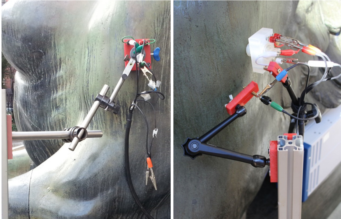
Figura 20. Brazo extensible (izquierda) y brazo articulado con bloqueo (derecha) para la sujeción de la celda y el electrodo de trabajo.
