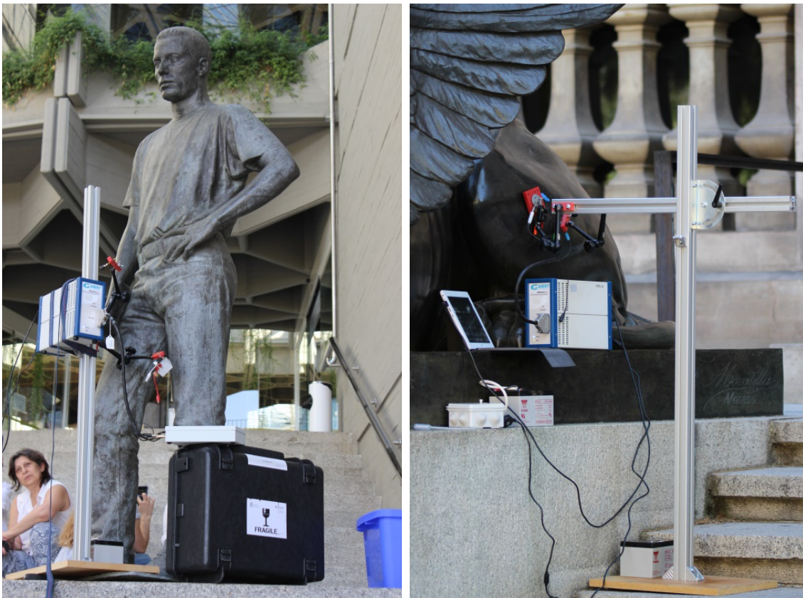
Figura 21. Sistema de barras de aluminio para la colocación de la celda y el potenciostato
