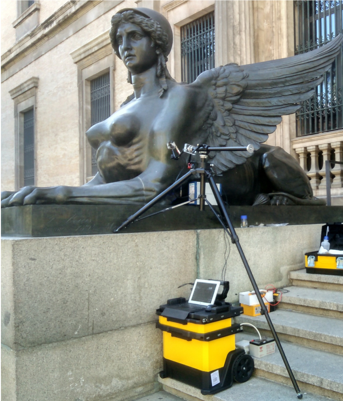
Figura 22. Montaje final de la celda sobre un trípode de fotografía. Para facilitar el transporte de los materiales y las baterías utilizadas para garantizar la autonomía del equipo se utiliza un caja de herramientas con ruedas.
