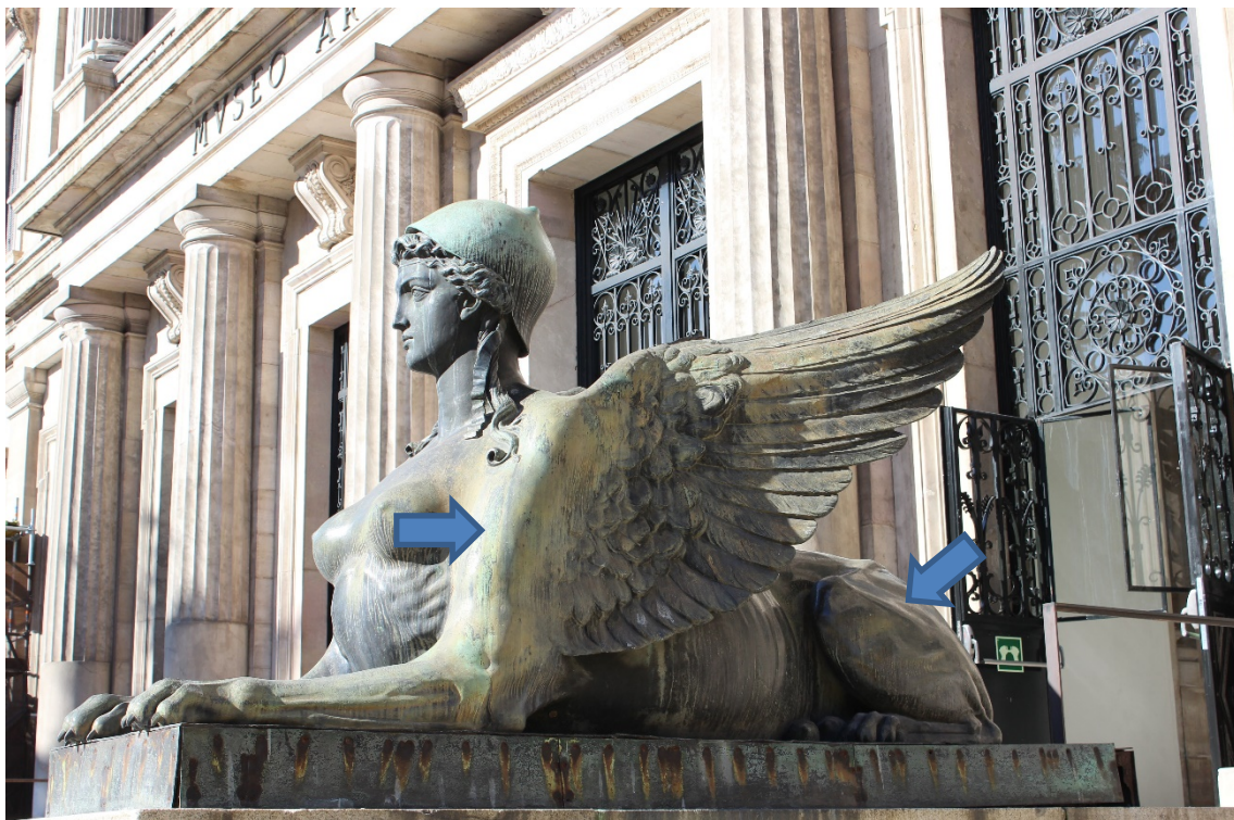
Figura 36. Esfinge de la fachada del Museo Arqueológico Nacional. Las flechas indican las dos áreas de la pátina sobre las que se han realizado las diferentes medidas.
