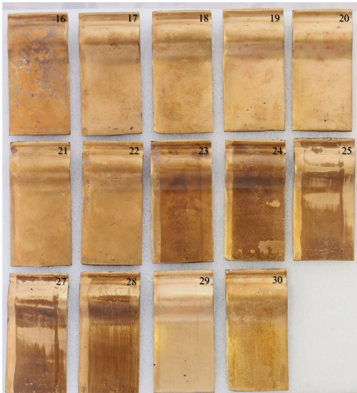
Figura 28. Probetas tras el envejecimiento artificial. [16: Sin recubrimiento; 17: Soter concentración 1; 18: Soter concentración 2; 19: Soter concentración 1, dos capas; 20: Soter concentración 2, dos capas; 21: Cosmolloid; 22: Cosmolloid, dos capas; 23: Paraloid B44; 24: Paraloid B44, dos capas; 25: Dos capas: Paraloid B44+Soter conc.1; 27: Dos capas: Paraloid B44+Soter conc.2; 28: Dos capas: Paraloid B44+Cosmolloid; 29: Tres capas: Soter conc.1+Paraloid B44+Soter conc.1; 30: Tres capas: Cosmolloid +Paraloid B44+Cosmolloid]
