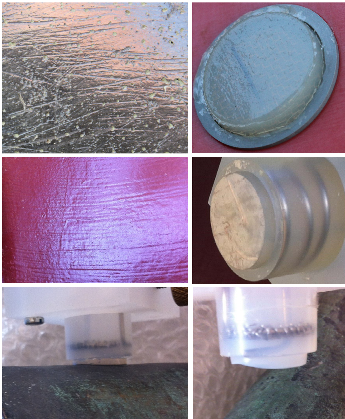
Figura 16. Capacidad de adaptación del gel a la textura y forma de la superficie medida.
