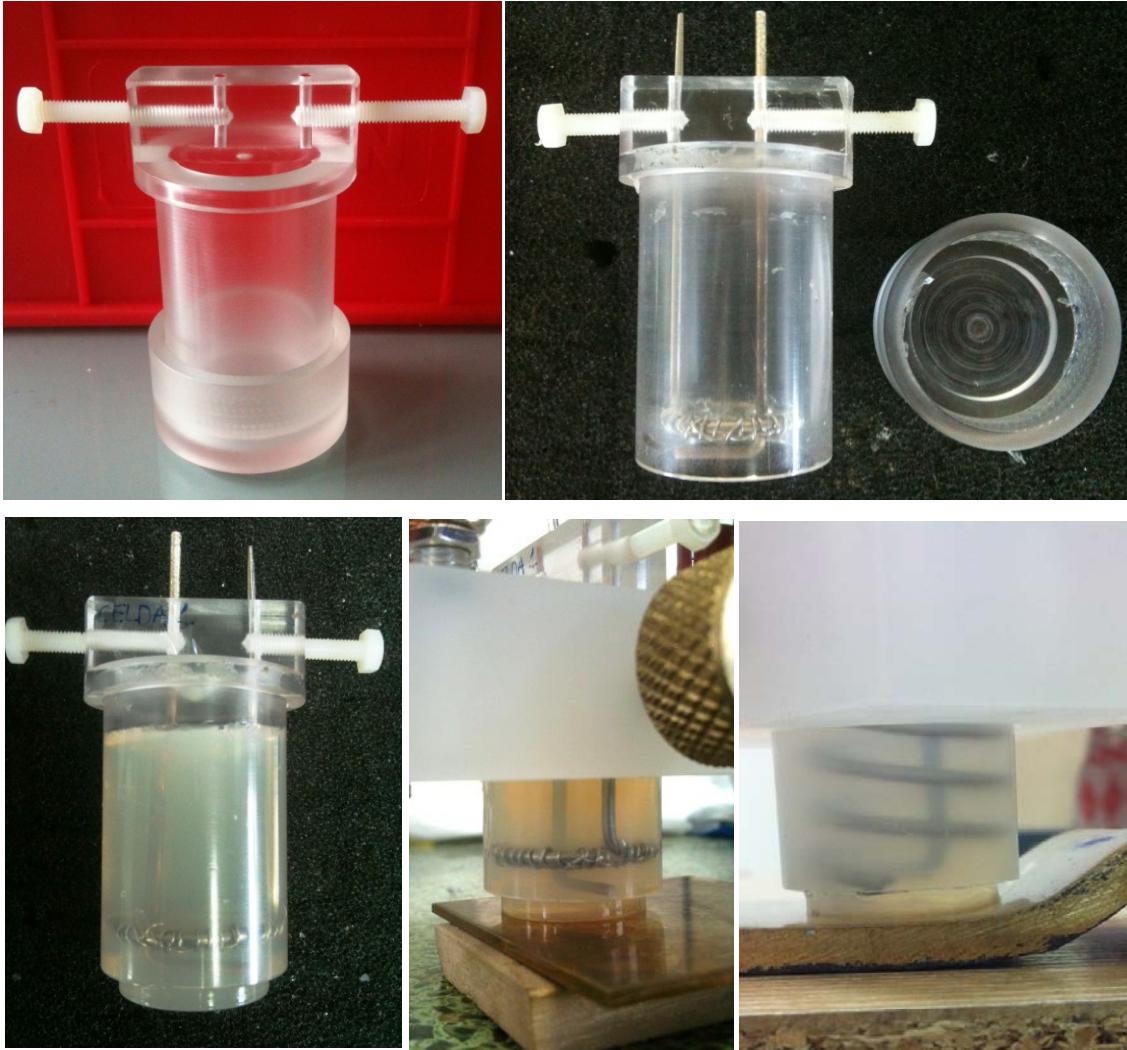
Figura 15. En las dos imágenes superiores se muestra el diseño final del molde de metracrilato, de dos piezas; en la parte superior se han realizado dos taladros para la colocación de los electrodos, que se sujetan a la altura deseada con dos tornillos de nylon. En las imágenes inferiores se puede ver la celda rellena con agar y el detalle de la colocación de la celda en contacto con una probeta metálica en una superficie plana (centro) y curva (derecha).
