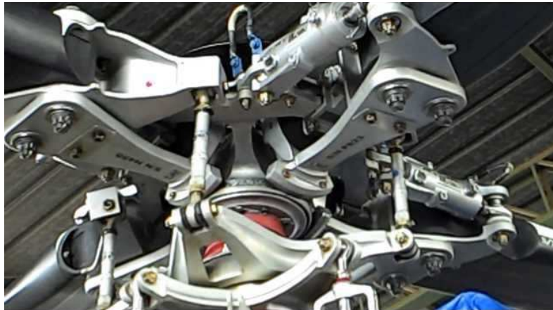
Imagen 1.1.2: Rotor articulado de helicóptero modelo Koala AW119.
