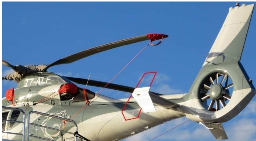
Imagen 1.1.5: Rotor de cola encapsulado del modelo EC155.
