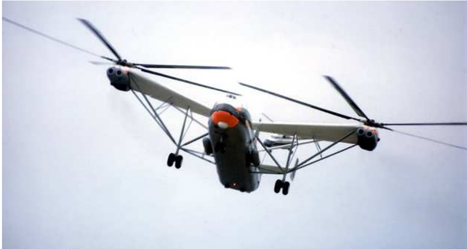
Imagen 1.1.9: Rotores transversales del Mil Mi-12
