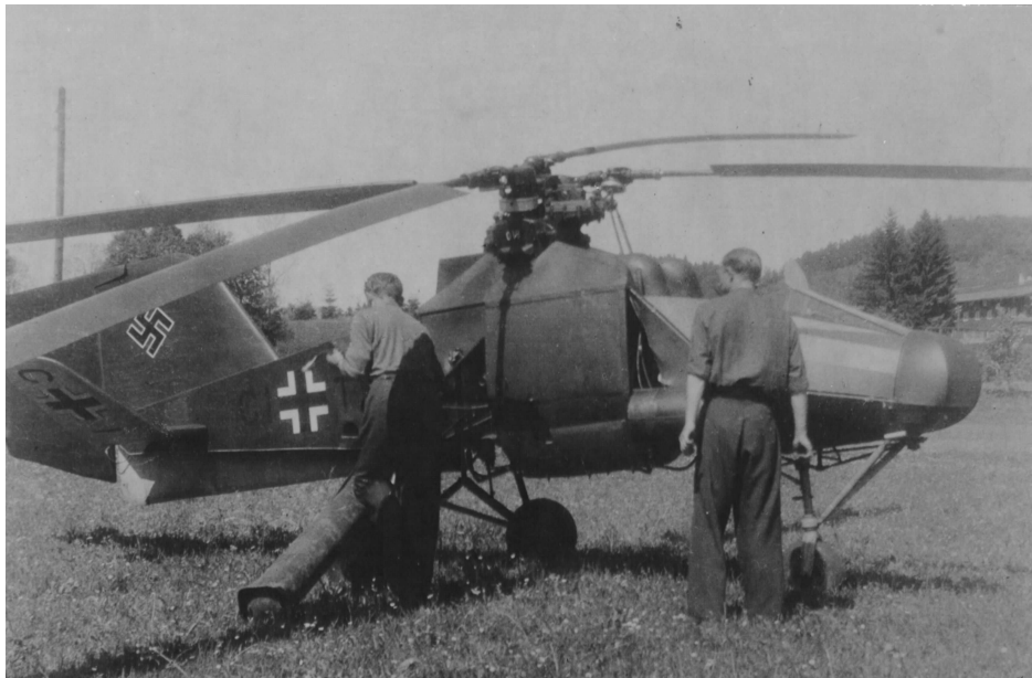
Imagen 1.1.10: Rotores entrecruzados de helicóptero Flettner Fl 282.
