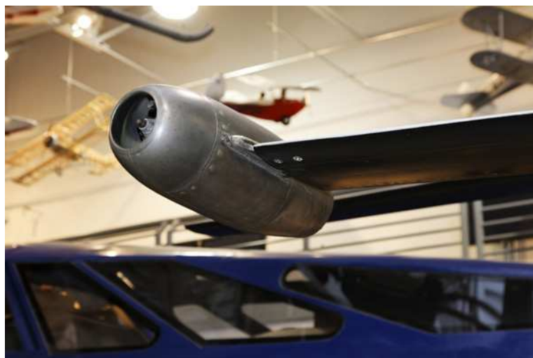
Imagen 1.1.7: Turbina en pala de helicóptero tipo 'Tip jet'.
