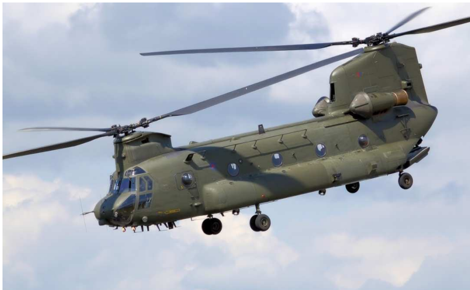
Imagen 1.1.8: Rotores tipo tándem en helicóptero modelo CH-47 CHINOOK.
