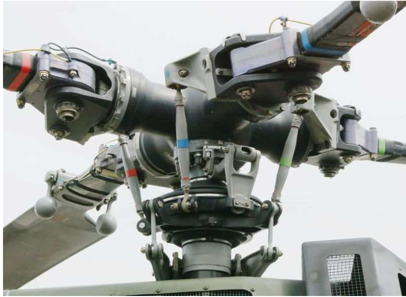
Imagen 1.1.3: Rotor rígido de helicóptero modelo BO-105.
