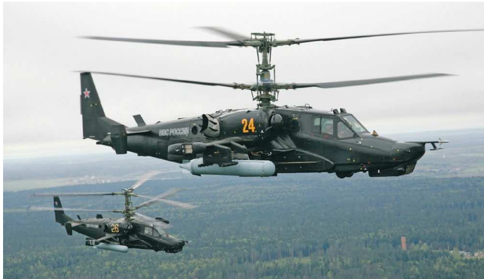
Imagen 1.1.11: Rotores coaxiales del Kamov KA-52 Alligator.
