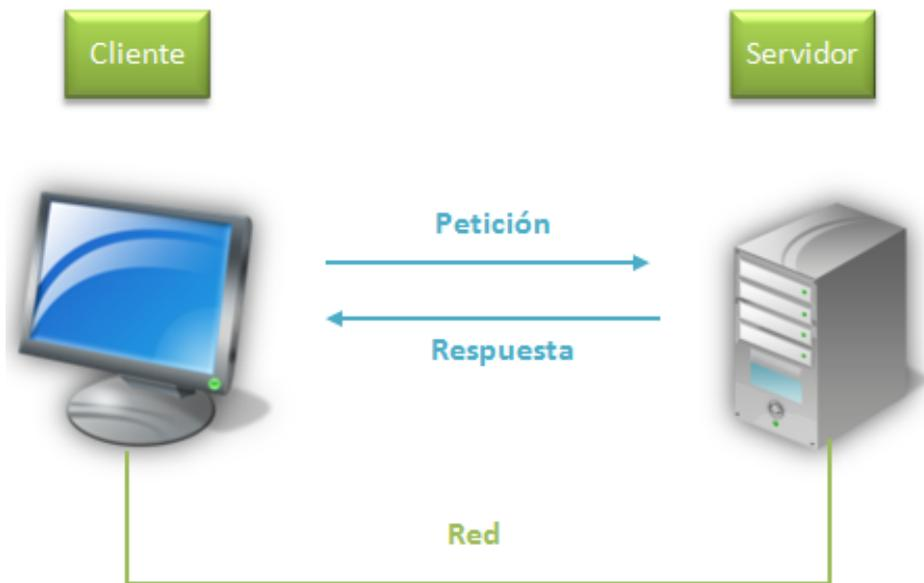
Ilustración 12. Modelo Cliente-Servidor [24]
