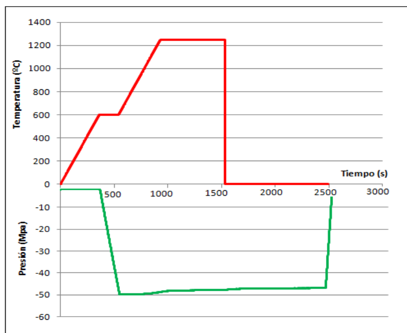
Figura 8. Esquema con el ciclo de presión y temperatura aplicadas.
