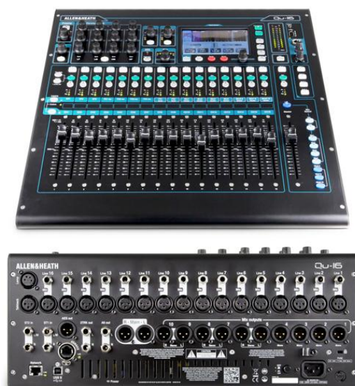
Ilustración 20: Mesa digital de mezclas compacta Allen-Health QU16
