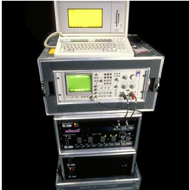
Ilustración 16: Sistema de medida Meyer SIM 3
